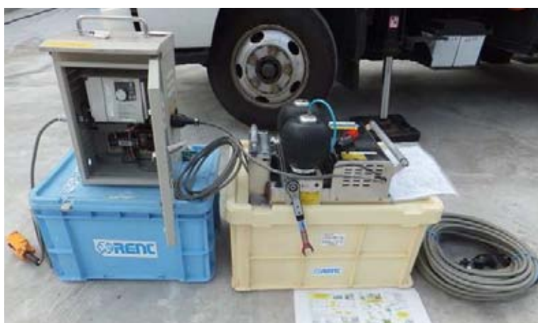
ケーブル延線機（パワーボール）
