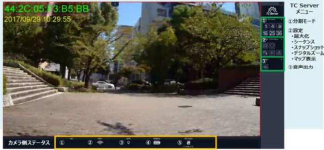
① 4G電波状況 ② WiFi電波状況 ③ GPS受信状況 ④ 電池残量 ⑤ SDカード容量
