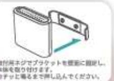
取付用ネジと専用スタンドを壁面に固定し、本体を取り付けます。ネジが当たるまで押し込んでください。
