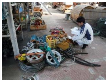
日奈久田浦線(架線工事) 持ち出し時、点検整備の実施
